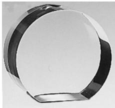
Pour déterminer l'indice de réfraction par la mesure de la vitesse de la lumière selon le procédé de modulation ; à faces polies.
