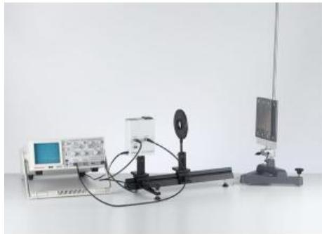
Dans l'expérience P5.6.2.1, on varie la distance parcourue par les impulsions lumineuses puis on mesure le changement du temps de propagation avec un oscilloscope.
