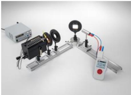
L'étude de la distribution angulaire du rayonnement réfléchi d'une surface réfléchissant de manière diffuse, par exemple, du papier mûre blanc, fait l'objet de l'expérience P5.5.1.3. Malgré le fait que la surface apparente varie avec le cosinus de l'angle d'observation, cette surface semble être de toutes parts uniformément claire aux yeux de l'observateur.
