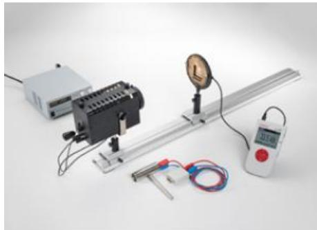
Dans l'expérience P5.5.1.1, on mesure l'éclairement énergétique à l'aide de la pile thermoélectrique de Moll et l'éclairement lumineux avec le capteur de lumière.
