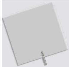
Permet d'observer des spectres et des phénomènes d'interférence ou de diffraction, même dans des salles mal obscurcies.
