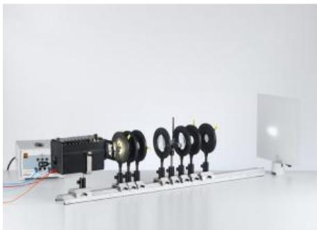
Dans l'expérience P5.4.2.3, on détermine la valeur et la direction des déformations dans des modèles en plastique transparents.
