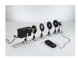
La loi de Malus fait l'objet de l'expérience P5.4.1.4. Si une lumière polarisée linéairement incide sur un analyseur, l'intensité de la lumière transmise est alors de
