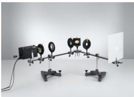
Dans l'expérience P5.4.1.1, de la lumière non polarisée se réfléchit sur une surface de verre: il s'avère en regardant à travers un analyseur que la lumière réfléchie est au moins partiellement polarisée.
