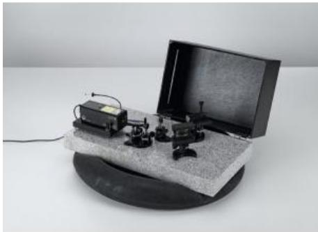
Dans l'expérience P5.3.7.1, on enregistre puis on reconstruit des hologrammes par transmission. On utilise un laser de classe de protection 2 pour ne pas inutilement mettre en danger lui de l'utilisateur. Suivant le traitement photochimique du film exposé, il est possible de réaliser des hologrammes d'amplitude et des hologrammes de phase.
