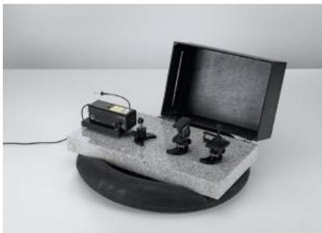
Dans l'expérience P5.3.6.1, on enregistre des hologrammes de réflexion en lumière blanche. On utilise un laser de classe de protection 2 pour ne pas inutilement mettre en danger l'utilisateur. Suivant le traitement photochimique du film exposé, il est possible de réaliser des hologrammes d'amplitude et des hologrammes de phase.
