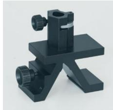
Cavalier pour banc d'optique à profil normalisé.
