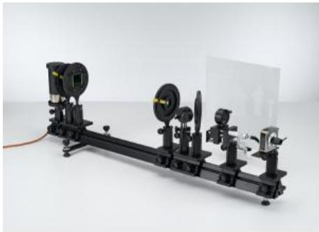
Dans l'expérience P5.3.4.4 on détermine d'abord la longueur d'onde  $\lambda$  de la raie spectrale verte d'une lampe spectrale Hg.
