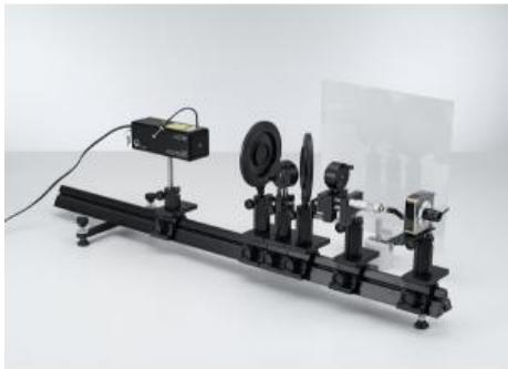
Dans l'expérience P5.3.4.3, on monte l'interféromètre de Michelson sur une banque d'optique. La longueur d'onde d'un laser He-Ne est déterminée après le changement de la figure d'interférence en déplaçant le miroir de l'interféromètre et le déplacement du miroir.
