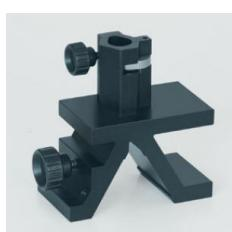
Cavalier pour banc d'optique à profil normalisé.
