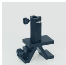
Cavalier pour banc d'optique à profil normalisé.
