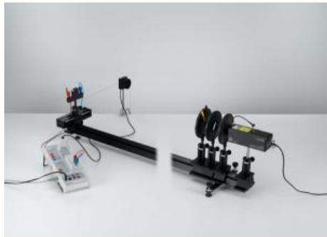
Dans l'expérience P5.3.1.5, on considère la diffraction par des fentes multiples.
