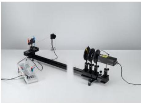
Dans l'expérience P5.3.1.4, on étudie la diffraction par une fente de largeur variable. Les valeurs mesurées enregistrées pour l'intensité I sont comparées avec le résultat d'un modèle de calcul réalisé pour de petits angles de diffraction dans lequel la largeur de fente b est retenue comme paramètre:
