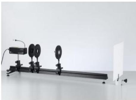
Dans l'expérience P5.3.1.1, on étudie les minima dintensité de diffraction par une fente.
