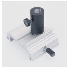
Support de fixation des lampes ( 450 60 ) et ( 450 64 ) ainsi que de l'écran ( 441 53 ) sur un banc d'optique à profil S1 ( 460 310 - 318 ).
