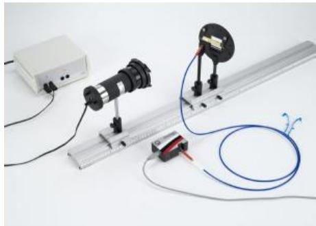
Dans l'expérience P5.2.5.1, la réflexion sur différents matériaux de la lumière d'une lampe à incandescence est enregistrée à l'aide d'un spectromètre.
