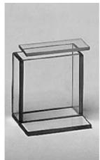
Pour effectuer des mesures dans le domaine de l'optique, telles que l'absorption ou l'extinction ainsi que pour la projection de phénomènes dans des liquides. Résistante à tous types de liquides, à l'exception des acides qui attaquent le verre, tels que l'acide fluorhydrique. Avec fond à bords saillants.
