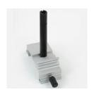
Support pour composants optiques à tige de 8 mm de diamètre.
