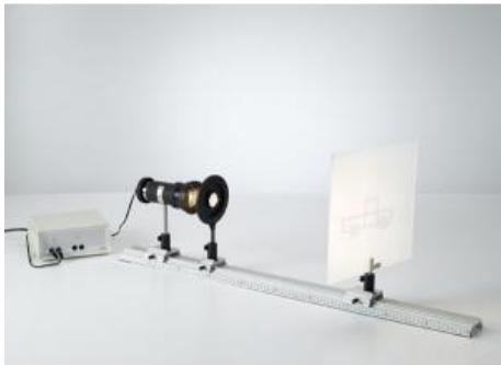
Pour la méthode de Bessel (P5.1.2.3), on installe un objectif et un écran d'observation séparés par une distance totale  $s$  fixe.
