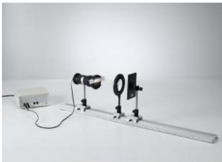
Pour la détermination par autocollimation (P5.1.2.2), un faisceau de rayons lumineux parallèles à l'axe optique est réfléchi derrière la lentille sur un miroir de manière à ce que l'image de l'objet soit directement à côté de l'objet.
