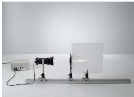
Dans l'expérience P5.1.2.1, un écran d'observation est placé parallèlement à l'axe optique de manière à ce qu'il soit possible de suivre sur l'écran la marche des rayons d'un faisceau de rayons lumineux parallèles à l'axe après son passage à travers une lentille convergente ou une lentille divergente.
