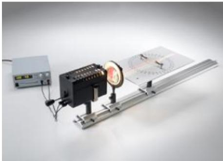
L'expérience P5.1.1.2 traite du changement de direction d'un rayon lumineux à la traversée d'une surface séparant deux milieux. La loi de la réfraction, découverte par W. Snell, est vérifiée quantitativement.
