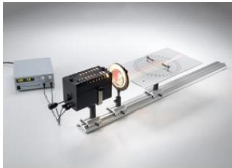
L'expérience P5.1.1.2 traite du changement de direction d'un rayon lumineux à la traversée d'une surface séparant deux milieux. La loi de la réfraction, découverte par W. Snell, est vérifiée quantitativement.
