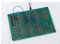
Au cours de l' expérience P4.5.2.1, on applique à l'enchaînement logique de quatre entrées les connaissances acquises avec les fonctions logiques de base en vue de construire des réseaux combinatoires complexes.
