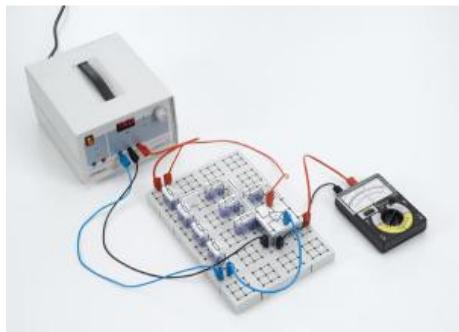
Dans l'expérience P4.2.2.4, on démontre l'addition ou la soustraction de plusieurs signaux entrée.
