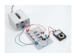
Dans l'expérience P4.2.2.4, on démontre laddition ou la soustraction de plusieurs signaux dentrée.
