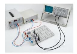
P4.1.7.1 d'un Tracé de caractéristique la phototransistor branché comme une photodiode
