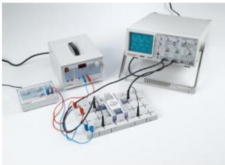
Dans l'expérience P4.1.6.5, le transistor à effet de champ comme amplificateur en mode circuit source et en mode circuit gate est étudié et les propriétés des circuits déterminées.
