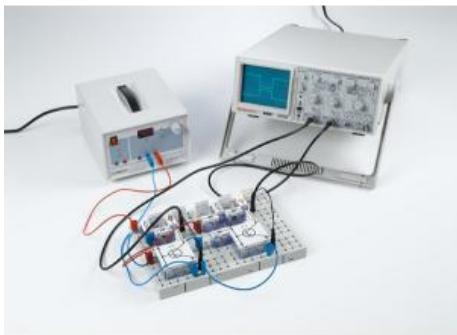
Dans l'expérience P4.1.6.4, un multivibrateur astable constitué de deux transistors bipolaires est monté et les influences des composants sur la fréquence ainsi que sur le rapport cyclique des vibrations sont étudiés.
