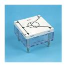
Étages préliminaires et interrupteurs pour faibles signaux.
