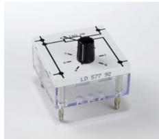
Réglage linéaire par bouton rotatif à index et échelle, utilisable comme résistance variable, diviseur de tension et générateur de tension alternative.
