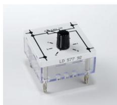
Réglage linéaire par bouton rotatif à index et échelle, utilisable comme résistance variable, diviseur de tension et générateur de tension alternative.
