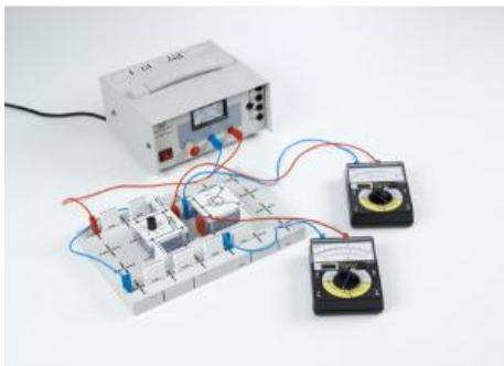
Dans l'expérience P4.1.5.2, on étudie les propriétés d'un transistor npn à l'appui de ses caractéristiques.
