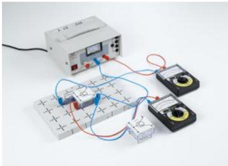
L'objet de l'expérience P4.1.5.1 est le montage de principe du transistor bipolaire puis sa comparaison avec une diode.
