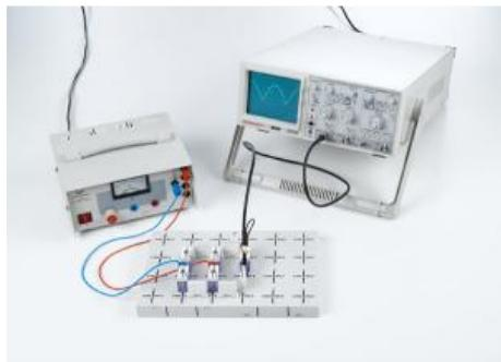
**P4.1.4.1 Redressement d'une tension alternative avec des diodes**
