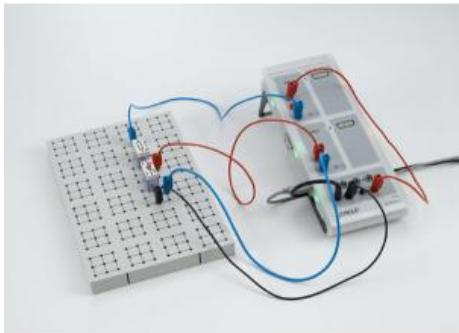
Dans l'expérience P4.1.3.6, on compare les caractéristiques de diodes électroluminescentes infrarouge, rouge, jaune et verte.
