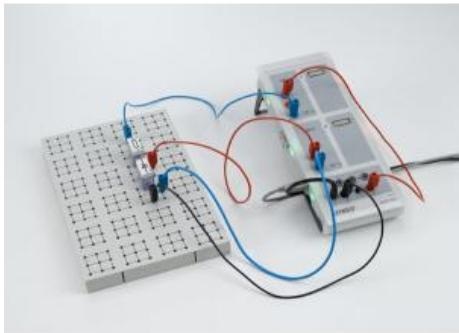
La caractéristique courant-tension d'une diode Zener fait l'objet de l'expérience P4.1.3.5.
