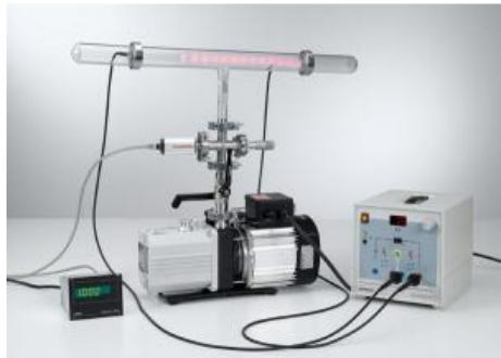
**P3.9.2.1 Étude de la décharge gazeuse autonome dans l'air en fonction de la pression**
