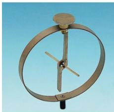
Pour des expériences de base et d'initiation à l'électrostatique ainsi que pour l'affichage de tensions continues et alternatives. Sert aussi à illustrer le fonctionnement d'un voltmètre haute tension de Braun. Convient pour la projection d'ombres. Livré avec une plaque de condensateur et deux douilles d'adaptation au silicium.
