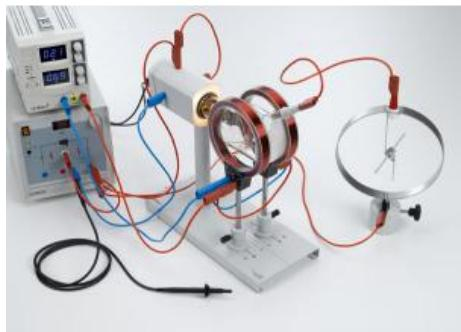
Dans l'expérience P3.8.4.1, on règle le courant avec une paire de bobines de Helmholtz, de manière à ce que le faisceau délectrons dans la cage de Faraday atteigne le tube de Perrin.
