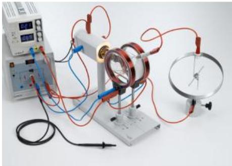
**P3.8.4.1 Thermoémission dans le vide: détermination de la polarité**
