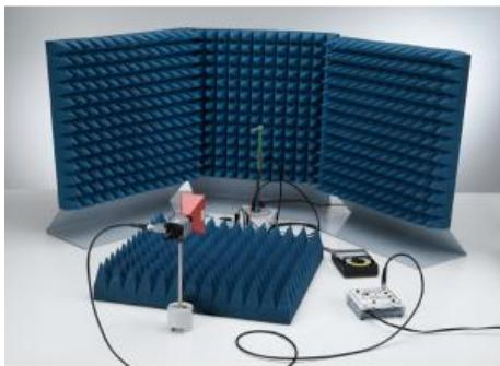
Dans l'expérience P3.7.6.2, on transforme une antenne dipolaire en une antenne Yagi à l'aide d'éléments passifs afin d'améliorer la propriété de directivité du montage.
