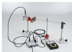
L'expérience P3.7.5.1 consiste cependant à étudier le guidage de micro-ondes le long d'une ligne de Lecher. Pour ce faire, on mesure la tension le long de la ligne à l'aide d'une sonde de champ électrique. On détermine la longueur d'onde à partir de l'écart entre les maxima.
