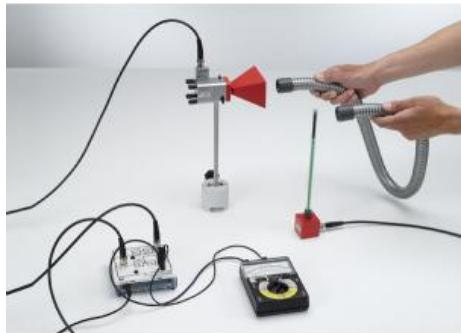
Dans l'expérience P3.7.5.2, on étudie la propagation de micro-ondes dans un guide onde métallique. On vérifie d'abord avec la sonde de champ électrique que l'intensité émise à côté de l'antenne à cornet est faible.
