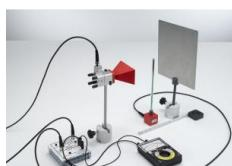
Dans l'expérience P3.7.4.3 on produit des micro-ondes stationnaires par réflexion sur une plaque métallique. L'intensité mesurée à un point fixe entre l'antenne à cornet et la plaque métallique change lorsque l'on déplace la plaque métallique dans le sens de la longueur.
