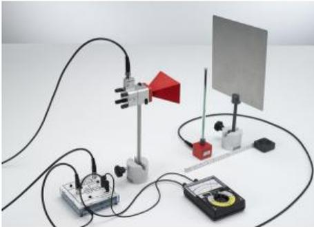
Dans l'expérience P3.7.4.3 on produit des micro-ondes stationnaires par réflexion sur une plaque métallique. L'intensité mesurée à un point fixe entre l'antenne à corne et la plaque métallique change lorsque l'on déplace la plaque métallique dans le sens de la longueur.
