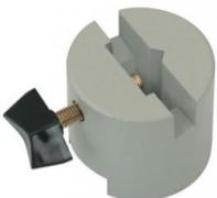
Pied cylindrique avec vis de fixation pour le serrage de plaques ou de tiges ; le dessous comporte une rainure rectangulaire qui lui permet de coulisser sur une règle graduée (par ex. 31102).
