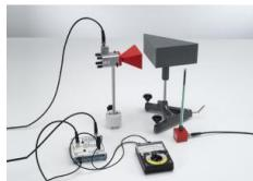
Dans l'expérience P3.7.4.6, on étudie la réflexion totale de micro-ondes sur un milieu optiquement assez fin. La mécanique des ondes dit que londe réfléchie pénètre le milieu optiquement plus fin sur 3 ou 4 longueurs d'ondes pour se propager le long de la surface limite en tant qu'onde de surface.
