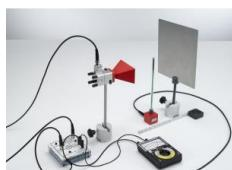
Dans l'expérience P3.7.4.3 on produit des micro-ondes stationnaires par réflexion sur une plaque métallique. L'intensité mesurée à un point fixe entre l'antenne à cornet et la plaque métallique change lorsque l'on déplace la plaque métallique dans le sens de la longueur.
