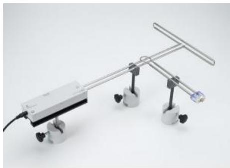
Dans l'expérience P3.7.3.2, on fixe un dipôle émetteur (dipôle trombone  $\frac{\lambda}{2}$ ) à l'extrémité de la ligne de Lecher.
