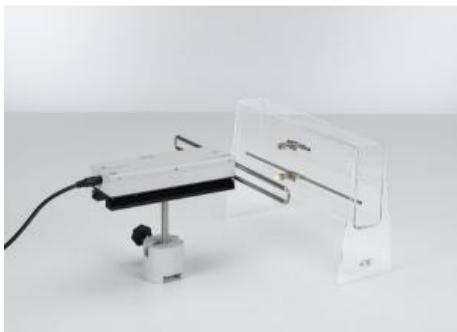
Dans l'expérience P3.7.2.4, on démontre la diélectricité de l'eau.
