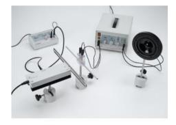
Lobjet de l'expérience P3.7.2.2 est la transmission des signaux de fréquence acoustique avec des ondes décimétriques modulées en amplitude.
