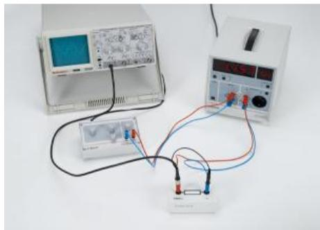
Dans l'expérience P3.6.6.4, on détermine expérimentalement les facteurs de crête, à savoir les quotients des amplitudes  $U_0$  et des valeurs efficaces  $U_{eff}$  pour différents signaux de tension alternative produits avec un générateur de fonctions.
