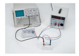
P3.6.6.4 Détermination des facteurs de crête de différentes formes de signaux du courant alternatif
