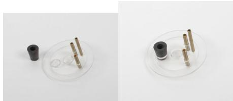
Composé d'un couvercle transparent avec possibilité de monter un filament chauffant (38422) ou un porte-échantillon (38423).
