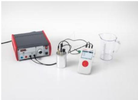
Dans l'expérience P3.6.6.1, on détermine la puissance électrique d'un thermoplongeur pour de petites tensions à partir de la chaleur cédée par effet Joule par unité de temps.
