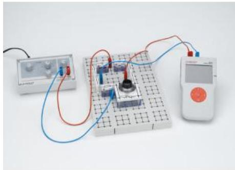
Dans l'expérience P3.6.4.2, on étudie le principe d'un pont de Wien pour la mesure d'une résistance capacitive  $Z_1$ .
