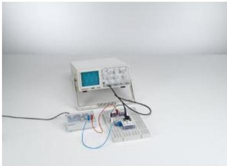
Dans l'expérience P3.6.4.1, on étudie le principe d'un pont de Wien pour la mesure d'une résistance capacitive  $Z_1$ .
