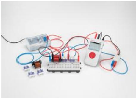
Dans l'expérience P3.6.3.6, on étudie le circuit oscillant en tant que montage série et parallèle de capacité et inductance.
